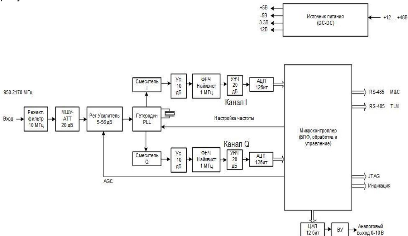
Рисунок 1.4.1 - Функциональная схема приемника сигнала наведения ПСН
